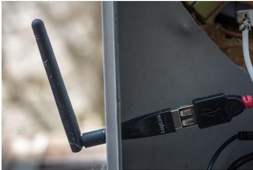
FIGURE 7.9 – Le dongle Wifi avec antenne extérieure.
